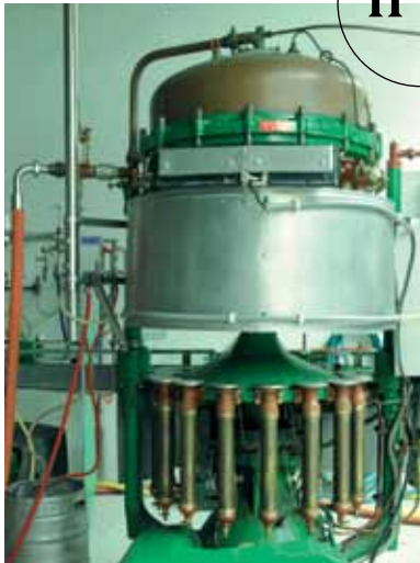
De bijzondere flessenvulmachine, ook geschikt voor de grote tweeliter beugelflessen.
